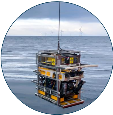
ROV进行海上风电维护
